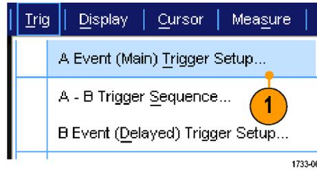
2. Définissez le type et la source du type de déclenchement A, dans l'onglet A Event. Sélectionnez **Format > 525i/NTSC**.
