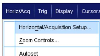
En mode Automatic, vous pouvez définir l'échelle et la fréquence d'échantillonnage. La longueur d'enregistrement est une variable dépendante. Si, suite à la modification de l'échelle, la longueur d'enregistrement dépasse la limite de longueur d'enregistrement, la fréquence d'échantillonnage est réduite au paramètre disponible suivant.
